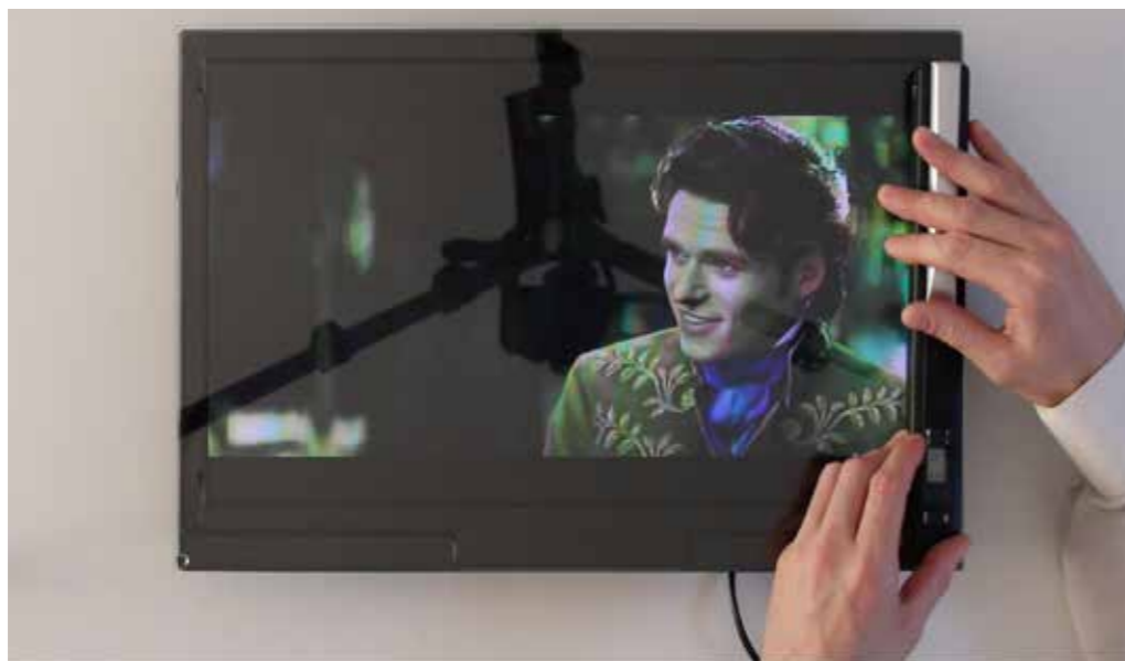
Einscannen des Bildschirms mit einem mobilen Scanner von links nach rechts.
